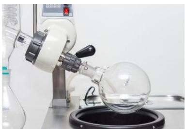
16. Monte el matraz evaporador (14) con la pinza del racord del matraz (13).
