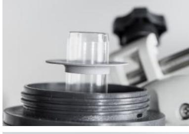
5. Monte las juntas tal y como se muestra en la foto. Coloque primero la junta gris.
