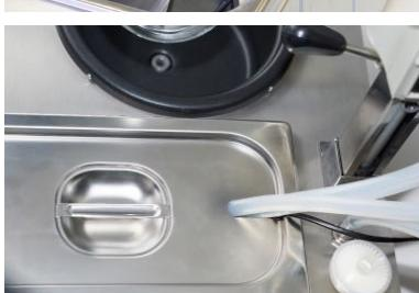
26. Una vez finalizada la conexión del refrigerante, coloque la tapa para evitar pérdidas de frío.
