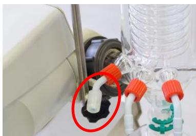
18. En la oliva marcada (en rojo) deberá instalar el tubo ancho. Antes, recorte unos dos centímetros aproximadamente del tubo fino, tal y como se indica en la foto.
