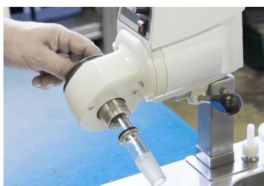
3. Instale el tubo de conexión del matraz (12).
