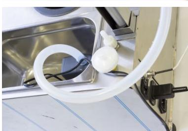
24. Instale la bomba de circulación del refrigerante (21) dentro de la cubeta de refrigeración (19).
