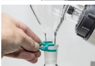
14. Instale el matraz receptor (9) con la pinza (4) insertándola a presión.
