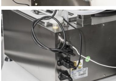
28. Detalle de las conexiones empezando desde abajo: toma de la red eléctrica (18), bomba circulación refrigerante (17) + (21), conexión alimentación motor reductor y conexión sonda de temperatura.
