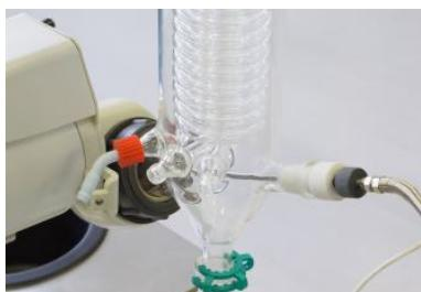
17. Monte la olivas y los rácores de salida y entrada (5) en las boquillas 22, 23 y 24.
