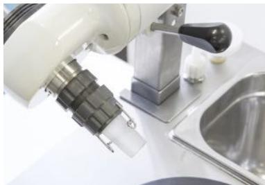
9. Monte y atornille el racord de fijación del matraz (13) de muestra.
