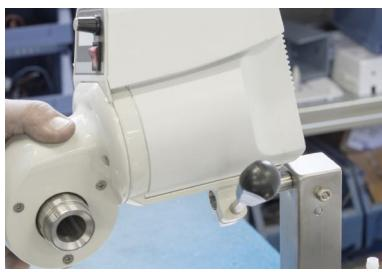
1. Instale el motor reductor angular (10) en su soporte.
