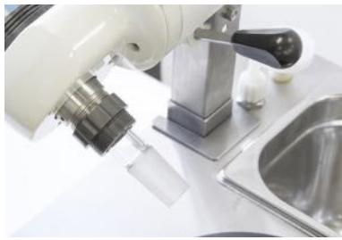
8. Monte y atornille el racord extensión de fijación del matraz (13) de muestra.
