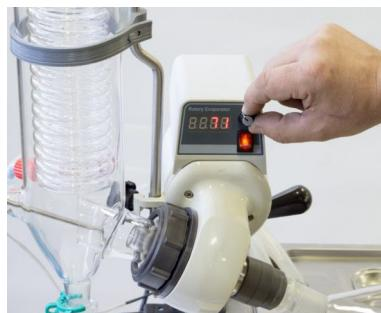
8. Accione el interruptor del motor (k) y ajuste su velocidad con el mando (j).
