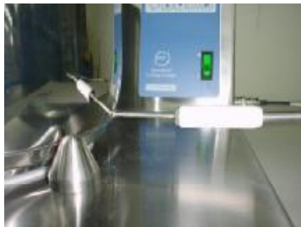
Foto 7. Sonda colocada en alojamiento en la base de la olla
