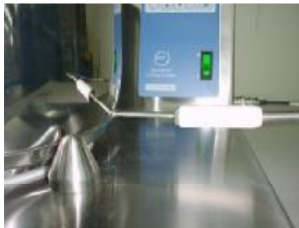
Foto 7. Sonda colocada en alojamiento en la base de la olla
